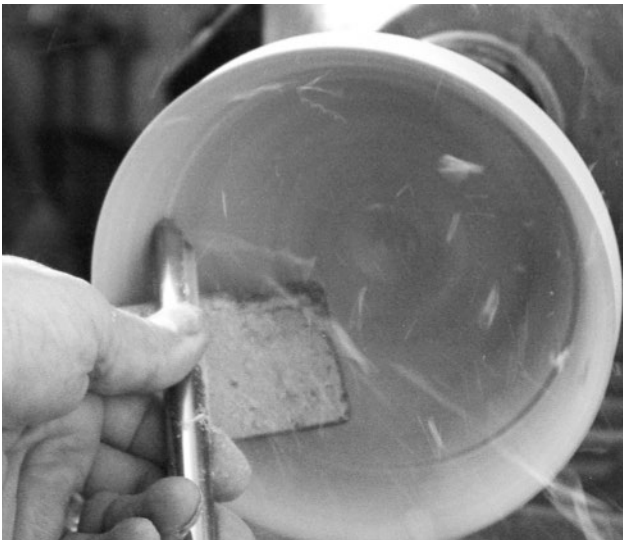
Beim Drehen einer Schale arbeitet man vom Rand zur Mitte und zum Fuß hin.
