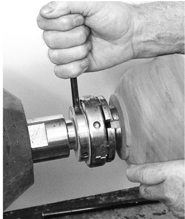
Drehen Sie die Schüssel um, wenn die Außenseite Form angenommen hat, und spannen Sie den Fuß in einem Spannfutter ein.
