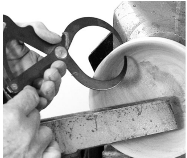
Man kann einen besonderen Außentaster (oder die eigenen Finger) benutzen, um die Stärke der Wandung auf Gleichmäßigkeit zu prüfen.
