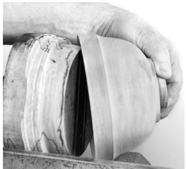
Um den Fuß einer Schale fertigzustellen, muss man oft ein auf Maß gearbeitetes Innenfutter selbst herstellen.
