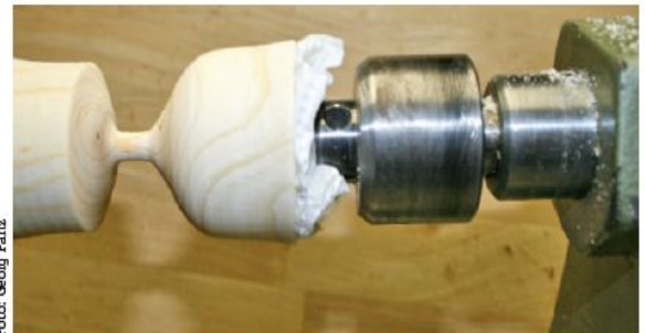
Die notwendige Führung bekommt der Kelch durch einen hineingesteckten Papierballen und den Reitstock.
