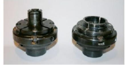
Tief hinein greifen die langen Spannzangen in diese Vasenrohling und halten das Werkstück auch im unrunder Zustand sicher.
