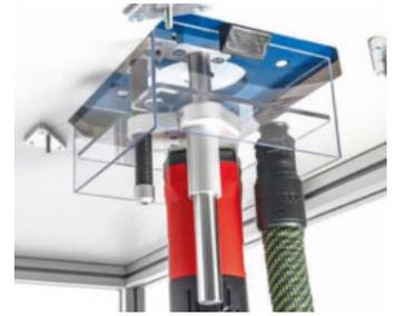
/ Die herunterfallenden Späne werden oberhalb des Motors abgesaugt.
