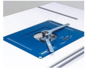
/ Die Frässpindel ragt über den Tisch und erleichtert so den Fräserwechsel.
