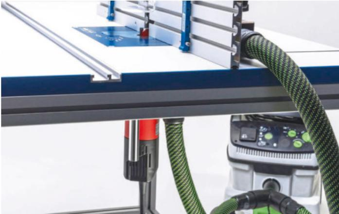
/ Beim FML-BR wurde die Liftkonstruktion komplett überarbeitet und verfügt nun auf der Unterseite über eine Acrylglas-Ummantelung mit integrierter Absaugung.
