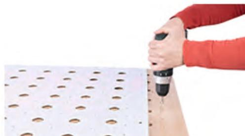
...und danach mit einem  $\varnothing 7,5$  mm Bohrer gebohrt.
