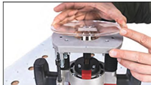
Sie befestigen die mitgelieferte Kopierhülse an Ihrer Oberfräse, um die Bohrungspositionen präzise zu übertragen.
