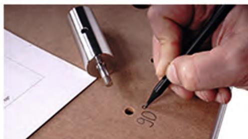
Ein mitgeliefertes Schema hilft Ihnen, die neue Arbeitsplatte mit den korrekten Winkelangaben zu beschriften.
